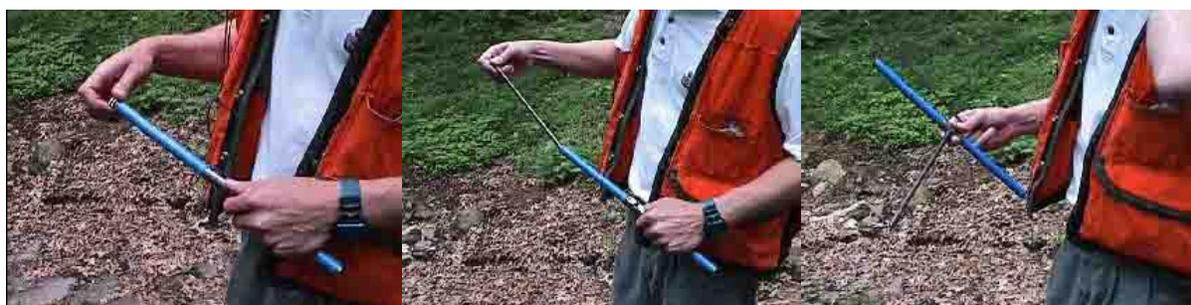
*Figura 2: Cómo montar un barreno de incremento.*
